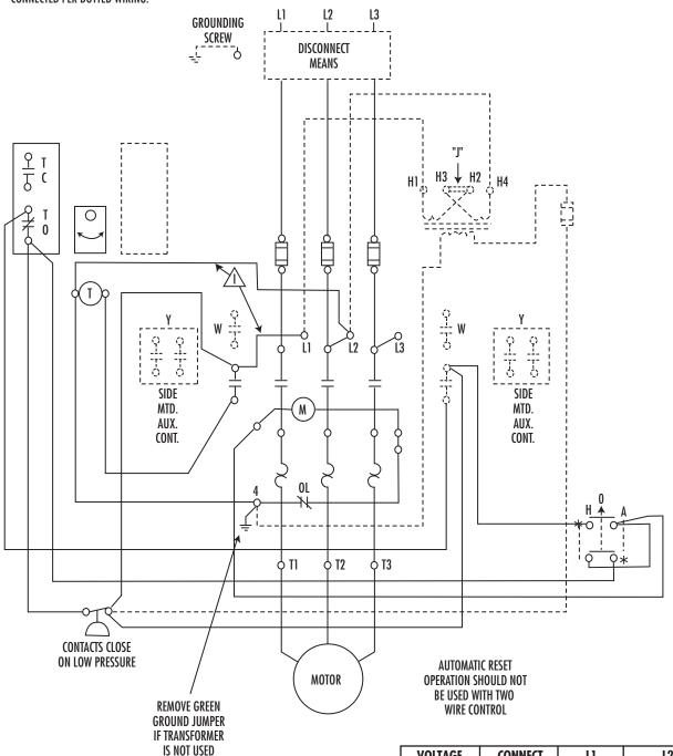
DUAL VOLTAGE TRANSFORMER IS SHIPPED AS SHOWN CONNECTED FOR HIGHER VOLTAGE. RECONNECT JUMPERS "J" PER TABLE FOR LOWER VOLTAGE.
